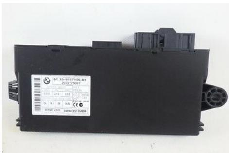
Centralina elettronica , Body Computer , ma anche definita centralina carrozzeria della BMW serie 3 (FRM) può guastarsi causando l'intermittenza della mancanza di funzionamento degli alzacristalli elettrici, degli indicatori, delle luci esterne e dei tergicristalli.
