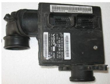
La centralina elettronica del motore della Mercedes Classe A e il misuratore della massa d'aria combinato sono componenti frequentemente soggetti a guasti sulla Classe A. I sintomi includono spegnimento del motore al minimo, irregolarità di funzionamento, perdita di potenza, problemi di alimentazione carburante (sovralimentazione o sottoalimentazione) e, infine, impossibilità di avviamento. Durante l'analisi con gli strumenti diagnostici, i codici di guasto frequenti registrati includono:
