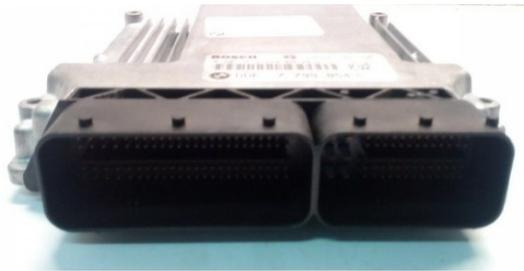
Il termine "centralina elettronica" può essere utilizzato in riferimento a un'unità di controllo del motore; tuttavia, esso può riferirsi anche a un'unità di controllo elettronico, che può essere un componente di un qualsiasi sistema mecatronico per autoveicoli, non necessariamente un dispositivo utilizzato per il controllo di un motore.
