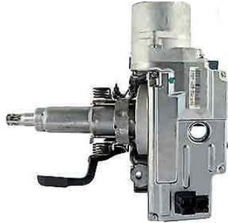
Il guasto del piantone con servosterzo elettrico (EPS) dei modelli Fiat Panda è frequente. Quando questo piantone si guasta, il servosterzo si disattiva in entrambe le direzioni e la spia PAS (servosterzo assistito) si accende in modo costante.
