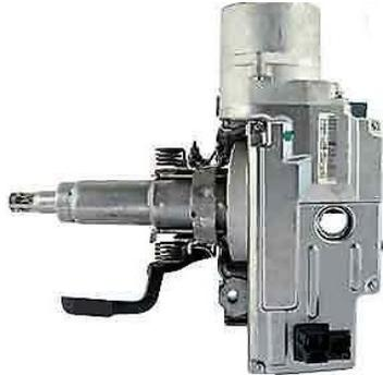
Servosterzo elettrico è soggetto a malfunzionamenti frequenti nelle Fiat Punto, che causano solitamente il guasto totale del servosterzo e l'accensione della spia del volante sul cruscotto (spia EPS). La disattivazione dell'assistenza del servosterzo rende molto difficili le manovre della vettura, soprattutto quelle per il parcheggio. Il guasto può essere intermittente, ma tende sempre a diventare permanente con il passare del tempo.
