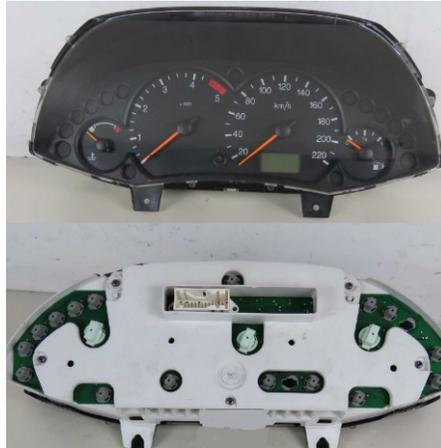
Il quadro strumenti delle Ford Focus è soggetto a guasti che causano il malfunzionamento intermittente di tutti gli strumenti, gli indicatori e le spie.
