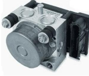
La pompa ABS nelle Honda è soggetta a guasti frequenti che causano l'accensione permanente della spia del sistema ABS. Il malfunzionamento interno della pompa ABS impedisce l'attivazione del sistema in caso di frenata di emergenza, per cui resta in funzione solo l'impianto frenante standard.
