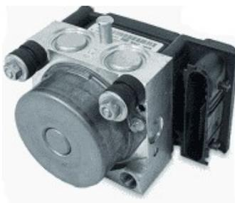
Si tratta di un problema frequente in tutti i veicoli Jaguar, che causa l'accensione della spia ABS sul cruscotto. L'analisi con gli strumenti diagnostici può riscontrare codici di guasto relativi al motorino della pompa idraulica o a uno o più sensori di velocità delle ruote. Questi codici spesso non possono essere cancellati finché i guasti interni alla pompa e al modulo ABS non vengono riparati.
