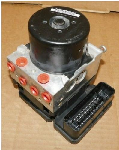
Questo modulo/pompa ABS WABCO è soggetto a guasti frequenti nei Land Rover Discovery. Se si nota che la spia ABS è accesa e si rilevano codici di guasto relativi alla commutazione della valvola selettiva, il problema dipende da questo modulo/pompa ABS e occorre ricondizionarlo.
