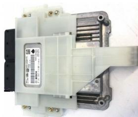
La centralina elettronica, nei vari modelli Rover è particolarmente sensibile in figura è rappresentata la centralina motore della Range Rover Evoque 2017, ma anche per i modelli Land Rover Defender e Discovery, quali lo spegnimento occasionale del motore. In genere, il motore si riavvia dopo qualche minuto, ma non sempre.
