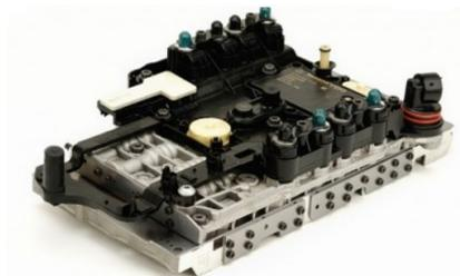
7G Tronic Plus è la centralina elettronica del cambio a sette marce di seconda generazione della Mercedes, progettata per contribuire al miglioramento del consumo di carburante e rendere il cambio delle marce più fluido. A differenza della versione precedente, questa centralina elettronica del cambio 7G Tronic Plus è progettata per lavorare con motori Start & Stop.
