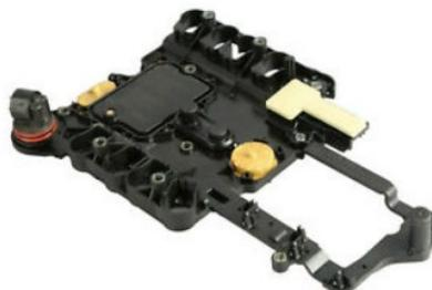
Questo è un guasto molto frequente per i veicoli Mercedes equipaggiati con il cambio automatico 7G-Tronic con codice cambio - 722.9, che spesso fa sì che il cambio mantenga troppo a lungo un rapporto prima di innestare aggressivamente quello successivo, causando un cambio marcia brusco e irregolare.
