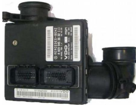
Questa centralina elettronica rappresenta un problema frequente nelle Mercedes e causa codici di guasto relativi al misuratore massa d'aria/sensore di flusso, regime minimo insufficiente e/o funzionamento irregolare.
