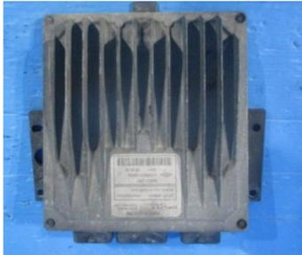
Centralina elettronica del motore è soggetta a guasti frequenti per i veicoli Renault con motore 1.5 .
