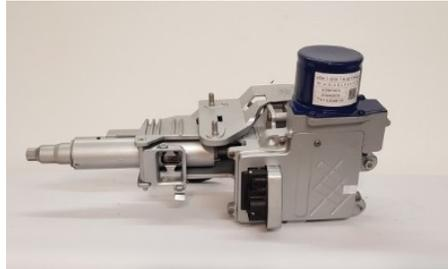
I veicoli Renault Modus, presentano un problema frequente che causa il guasto improvviso e totale del servosterzo. Il guasto si manifesta con la disattivazione completa del servosterzo e il messaggio "Steering Fault - Stop Engine (guasto allo sterzo - arrestare il motore)" sul cruscotto.
