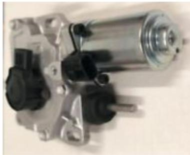
Gli attuatori della frizione e del cambio installati sui cambi Multimode (MMT) Toyota sono soggetti a guasti frequenti, che impediscono la selezione delle marce rendendo impossibile la guida del veicolo. Questo spesso attiva il lampeggiamento del simbolo N sul display di selezione delle marce.
