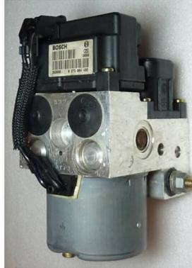
Pompa ABS soggetta a guasti frequenti nei modelli Alfa Romeo. Il guasto causa l'accensione della spia ABS e del freno a mano sul quadro strumenti.
