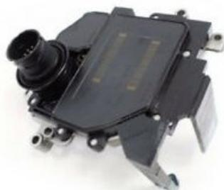
Centralina elettronica del cambio DSG Volkswagen e Audi (guasto del modulo meccatronico).
